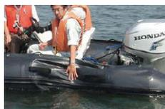
トランサムに最も近いチューブが損傷しても船外機を保持し走行が可能。
